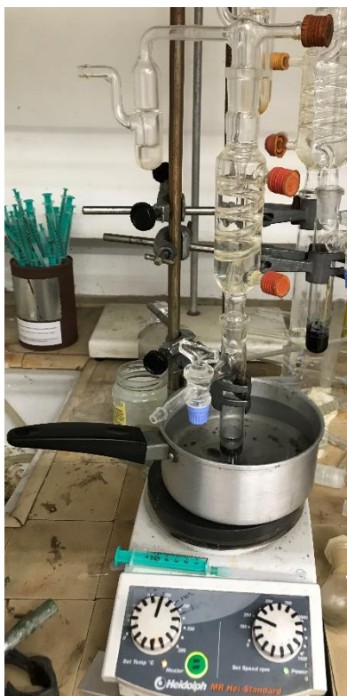
Figura 15 - Montagem utilizada para a realização da despolimerização redutiva do P4HB.
